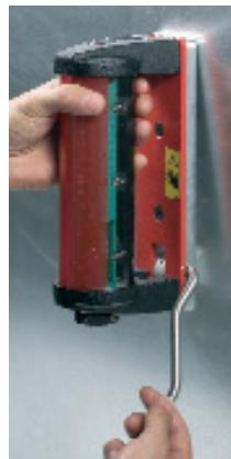
Antes de conectar el receptor al brazo mecánico, bascule la palanca de desacoplamiento hacia abajo. Esta manivela crea un espacio entre la tarjeta maestra y la máquina y evita que el imán se adhiera totalmente al metal.
